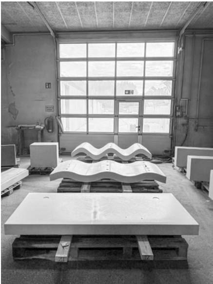
Einzelteile Altar nach Kunststeinguss
